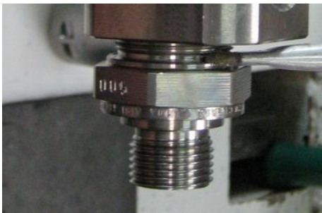
Abb.3 Montage der Eintrittskörpers
