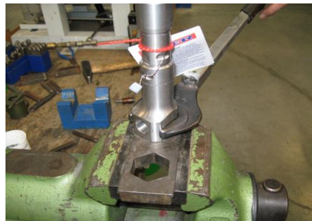
Abb.4 Montage des Austrittskörpers mit einem fest definierten Drehmoment
