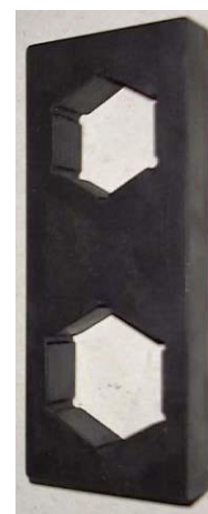
Abb.1: Montagehilfe für 6-kant Eintrittskörper
