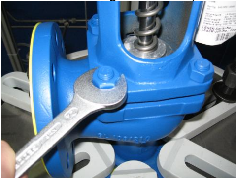
Abb.1 Lösen der Verschraubung
