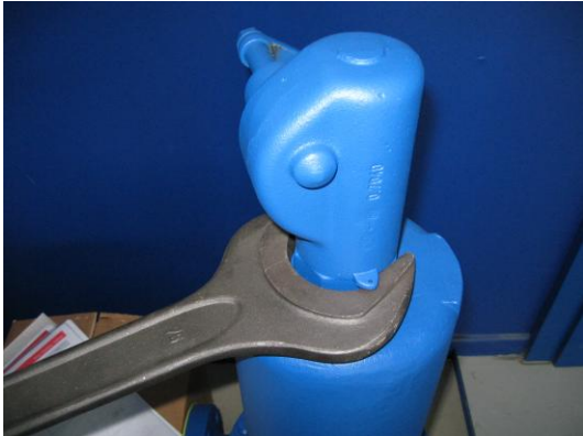
Abb.3 Montierung der Anlüftung und Kappe
