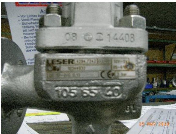
Abbildung 6.2.1-6: Standardschild am Flanschventil
