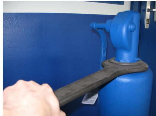
Abb.3 Montierung der Anlüftung und Kappe
