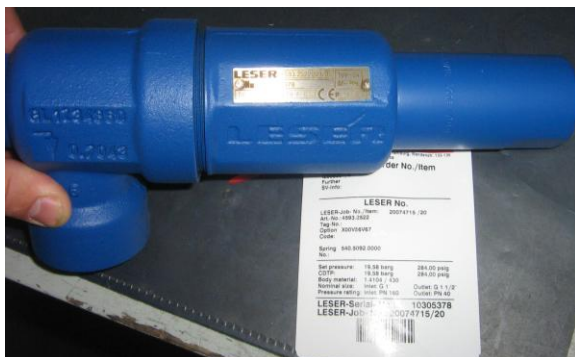
Abbildung 7.1-2: Kontrolle der Typnummer gegen den Ventilprüfplan / Reparaturauftrag
